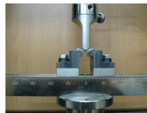
نگاره‌ی ۲ آزمون استحکام خمشی (Three point bending)
