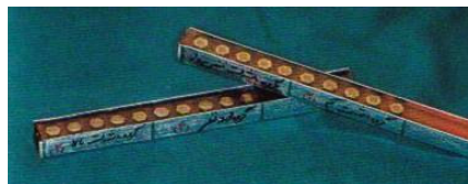
نگاره‌ی ۶: قالب آلومینیومی دارای اپوکسی رزین دربرگیرنده‌ی نمونه‌ها
