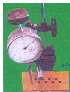
نگاره ی ۲: دستگاه سنجش عمق گلوله های پولادی
