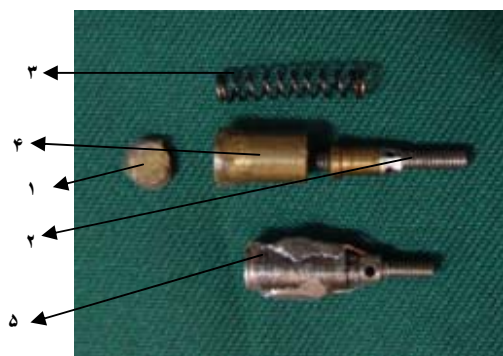
نگاره ی ۱: پیچ طراحی شده ی گسترش فکی (اجزای اصلی: ۱: درپوش، ۲: میله پیستونی، ۳: فنر، ۴: استوانه ی لبه دار، ۵: مجموعه ی به هم پیوسته)
