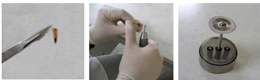
نگاره ی ۲: شست و شو، برداشتن لاک با تیغه ی بیستوری و برش دندانها با دیسک پس از خارج شدن از فوشین آبی
