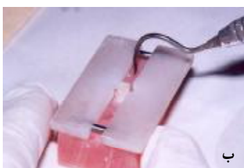
نگاره‌ی 1 الف: مولد تفلونی نگاره‌ی 1 ب: طرز جداسازی مولد تفلونی نگاره‌ی 1 پ: نمونه‌ی آماده شده پیش از قرار دادن در سرم فیزیولوژی
