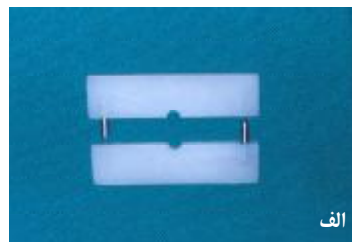
نگاره‌ی 1 الف: مولد تفلونی نگاره‌ی 1 ب: طرز جداسازی مولد تفلونی نگاره‌ی 1 پ: نمونه‌ی آماده شده پیش از قرار دادن در سرم فیزیولوژی
