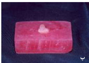
نگاره‌ی 1 الف: مولد تفلونی نگاره‌ی 1 ب: طرز جداسازی مولد تفلونی نگاره‌ی 1 پ: نمونه‌ی آماده شده پیش از قرار دادن در سرم فیزیولوژی
