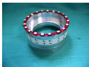
نگاره ی ۱: نگهدارنده ی فلزی استوانه‌ای شکل که نمونه‌ها بر روی آن نصب شده اند.
