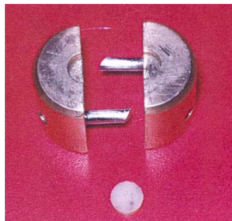
نگاره ی ۲: مولد برنجی و دیسک کامپوزیتی خارج شده از مولد
