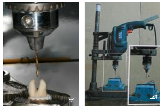
نگاره‌ی 1-الف: دستگاه استاندر برای نگهداری دندان، ب: مسیر حرکت مت‌ها برای ایجاد حفره‌ی پرفوراسیون
