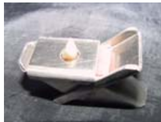
شکل ۲: دندان مانت شده در آکریل درون مولد
