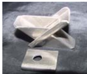
شکل ۱: مولد آلومینیومی برای مانت کردن دندان ها
